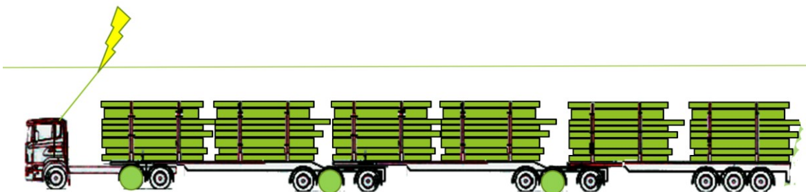
Figur 5 Dragbil med flera efterfordon med separata framdrivningssystem, drivande hjul grönmarkerade.
