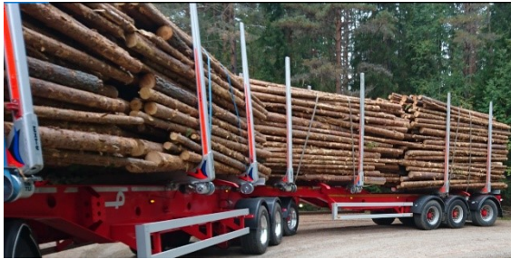
Figur 20. Lägre lasthöjd och mindre mellanrum mellan lastdelarna ger ett lägre luftmotstånd.
