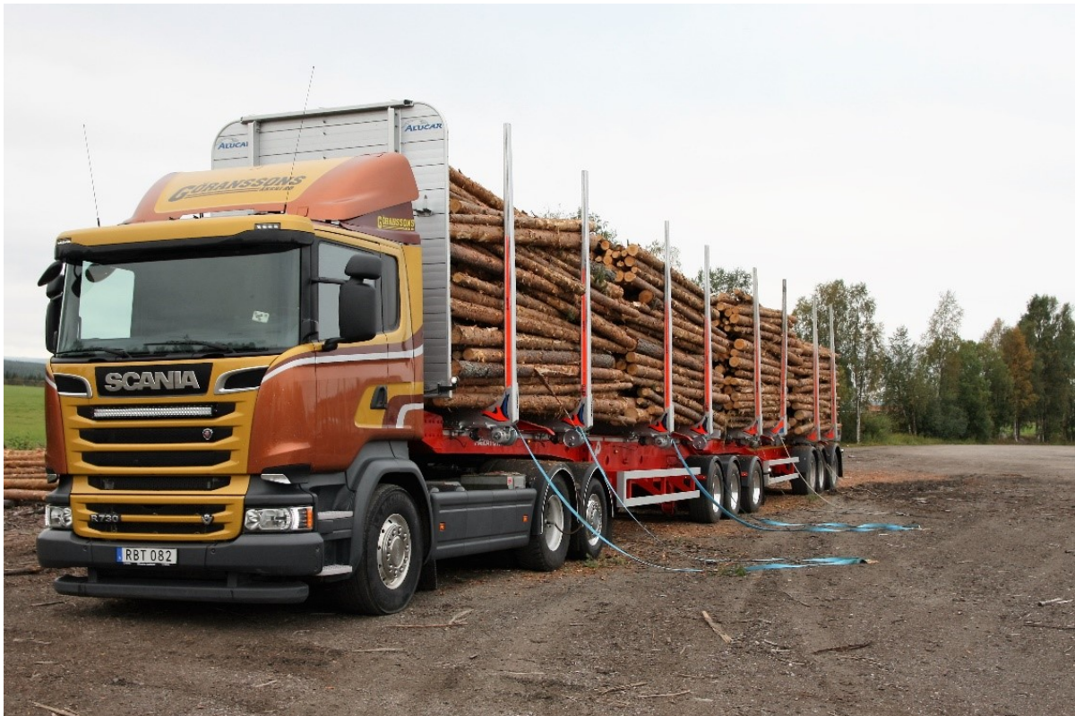
Figur 4. ETTPush-bilen 9 september 2016 provlastning av 4 travar till bruttovikt 74 ton.
