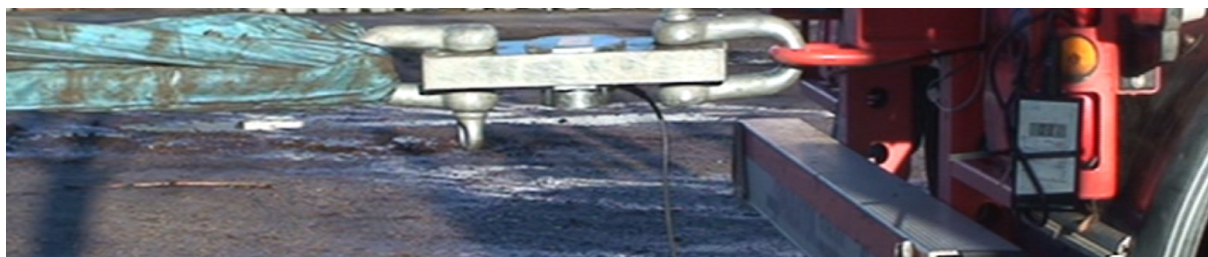
Figur 9. Dragkraftsgivare mellan två lyftöglor som monterats mellan försöksfordonet och en hjullastare.
