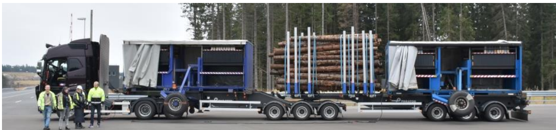
Figur 7: ST-drag lastad med upphissade betongplattor samt en timmertrave, tyngdpunkten blev motsvarande timmertravar lastade till 4,5m totalhöjd.
