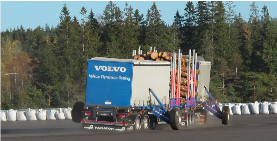
Figur 8: ST-drag körd tills något stödhjul tar i vägbanan, detta innebär att ekipaget skulle välta om inte stödhjulet tagit emot.
