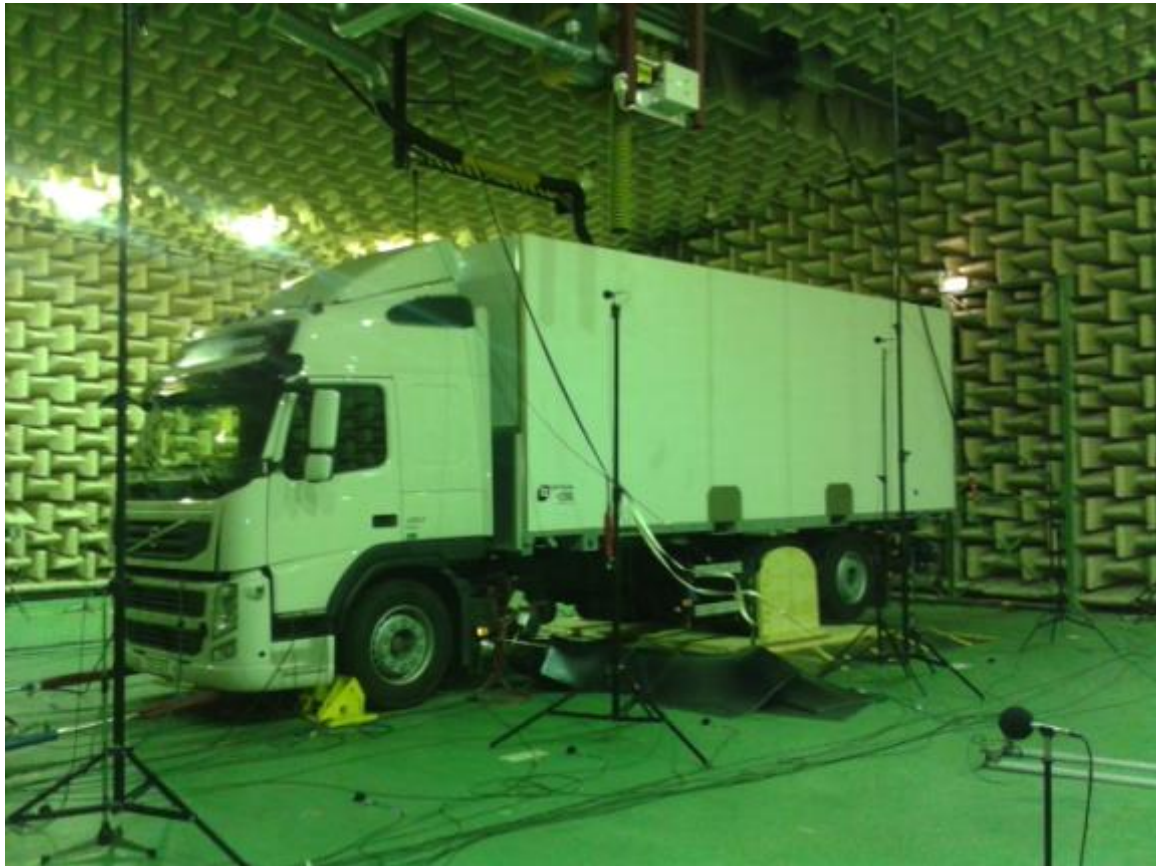
Figur 3, Projektfordonet i det Semi-Ekofria rummet vid Volvos Ljud och Vibrations laboratorie
