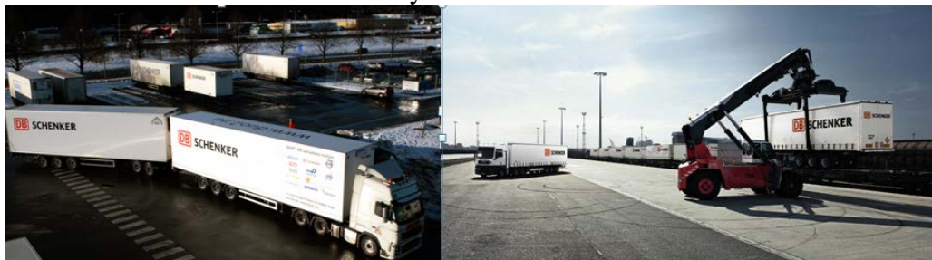
Figur 6. DUO 2 ekipage på terminalområde samt exempel omlastning väg-järnväg
