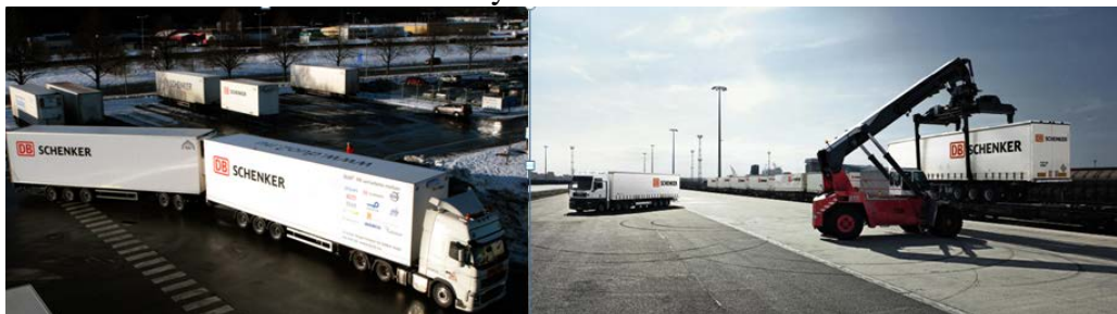
Figur 6. DUO 2 ekipage på terminalområde samt exempel omlastning väg-järnväg
