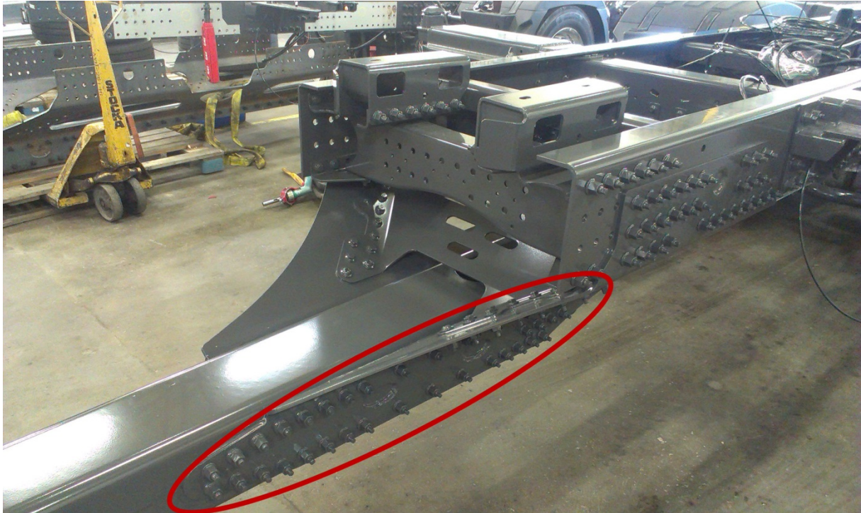
Figur 2: De specialutformade skruvförbanden
