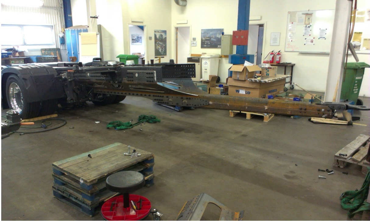
Figur 4: Dragstång provmonterad på kärna
