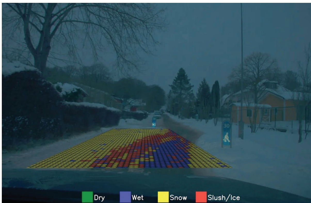
Figur 19. Exempel på hur systemet detekterar väglaget framför fordonet (källa Klimator).
