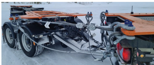
Figur 43. Vagnar som monterats på semitrailrar för att förhindra jackknifing.
