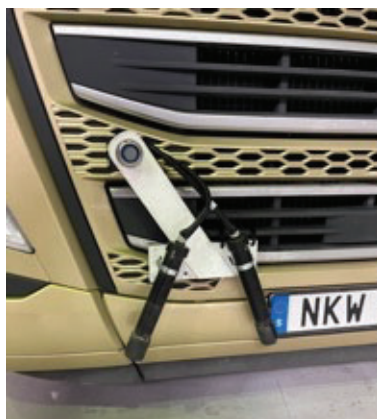
Figur 18. Lasersensorer för väglagsmätning installerad i fronten på Budbolagets dragbil.
