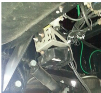
Figur 16. Goodyears datamottagare för däcksensorer monterad under en semitrailer.
