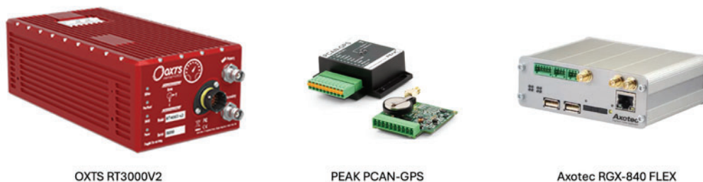
Figur 13. Några olika GNSS-enheter som användes i projektet. Dessa har även accelerometrar för tröghetsmätning (IMU).
