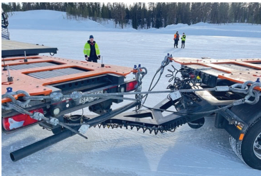
Figur 23. Jackknifskydd mellan första och andra semitrailer som användes vid vinterprov.
