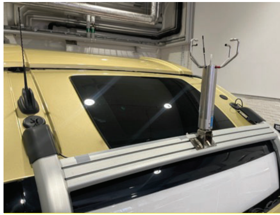
Figur 17. Anemometern monterad på Budbolagets dragbil.
