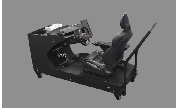
Figur 2. Mobil körmiljö som utvecklades i projektet för att skapa en kontrollerad miljö för datainsamling på flera olika orter.
