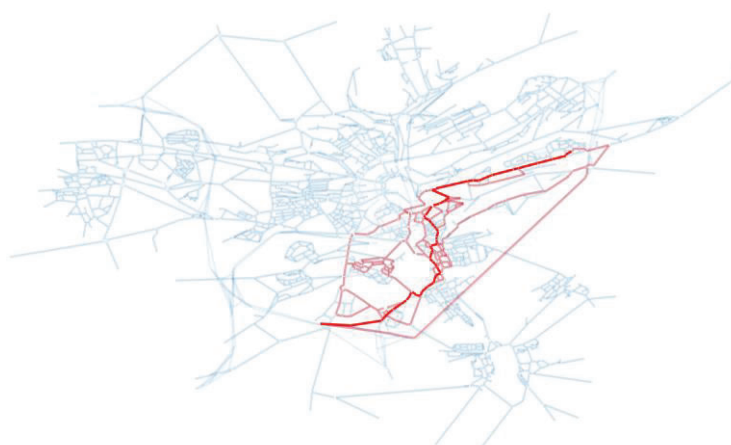
Figur 1: Utforskning av energieffektiva rutter genom Luxemburg med hjälp av Thompson Sampling (där vägnätet är baserat på kartdata från OpenStreetMap ).
