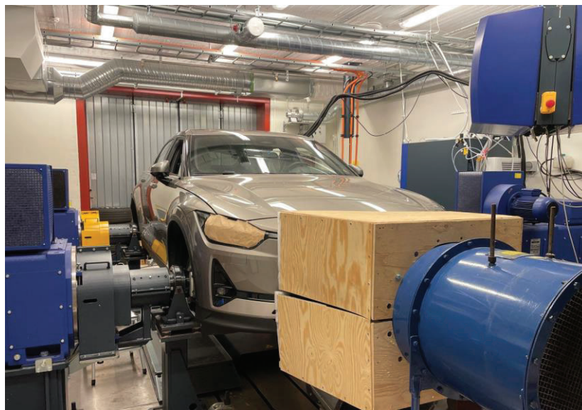
Figur 2: Prov med elfordon i Chalmers hybridtestcell för att validera antaganden om energiförbrukningsmodeller.
