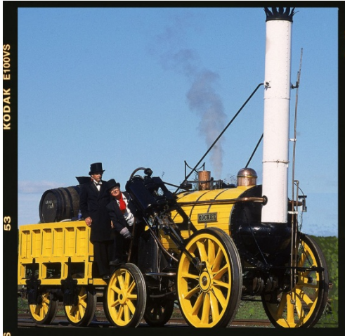
Ångmaskinen är nog den viktigaste symbolen för uppfinningar. Hade historien utvecklats som den gjorde om inte patentsystemet hade funnits? Bilden visar en rekonstruktion av ångloket "The Rocket" byggt av Robert Stephenson and Company år 1829. Loket vann över "Novelty" vid tävlingen i Rainhill i oktober 1829. Fotografiet är taget när det rekonstruerade loket gjorde ett Sverigebesök för några år sedan. Foto: Per Frankelius.
