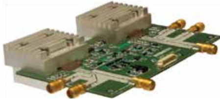
Mottagar- och sändar-moduler för E-bandet tillverkade av Sivers IMA inom MODEM-projektet
