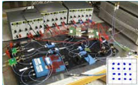
Mätuppställning för test av ett 16 QAM system med ett konstellationsdiagram där de 16 tillstånden tydligt framgår, se infälld bild.
