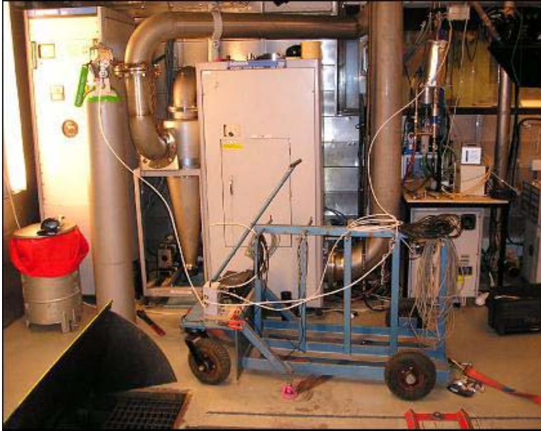
Bild 7: Uppställning för mätning spädfaktorer, Avg-lab 3
