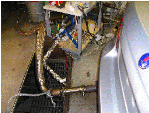
Bild 16: EMIR-system med värmd ledning från avgasrör
