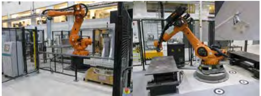
Robotstation med "Collaboration" vid högskolan Väst, Produktionstekniskt Centrum. Inspektion av svetsade objekt till vänster (Volvo Aero scenario), och robot med integrerat Safety Eye (Pilz) kamerasystem till höger för generell studie kring "Collaboration"
