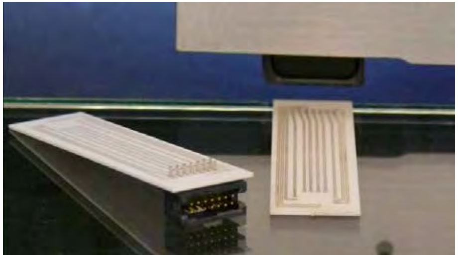
Keramiska substrat med metalliska ledarmönster tryckta med inkjet teknik
