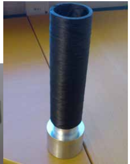
Höger: Kompositrör som fästs i metall genom kombination av smältformning och termisk krympning vid avsväljande
