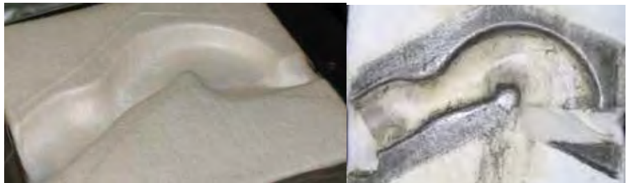
Vänster: Tribotextil formad efter verktygsgeometrin efter 1 slag
