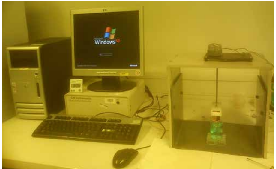
Laborarieuppställning av rigg för elektroplatering med succesiv doppning
