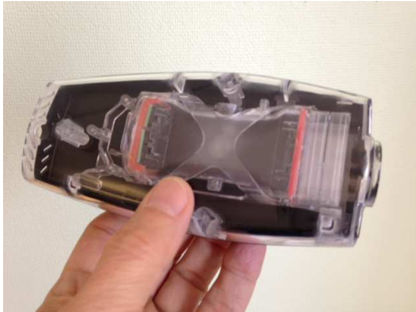
Fig 3. Transparent modell av det kompletta sensorsystemet.
