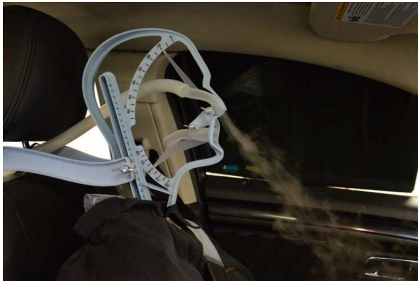
Fig 6. Flödesexperiment i fordonskupé med simulerad utandning från ett artificiellt ansikte.
