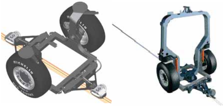
Translohrs styr- och bärhjulramar (Lohr)
