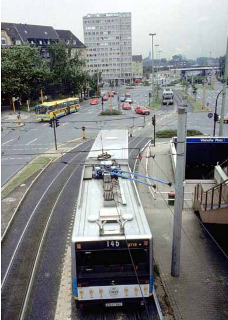
Kantstödsstyrda tråddledbussar på spårvägsspår i Essen. Observera de dubbla kontaktledningssystemen. Med en extra spårvägsantograf och spänningsomformare i bussen kunde installationen gjorts enklare.
