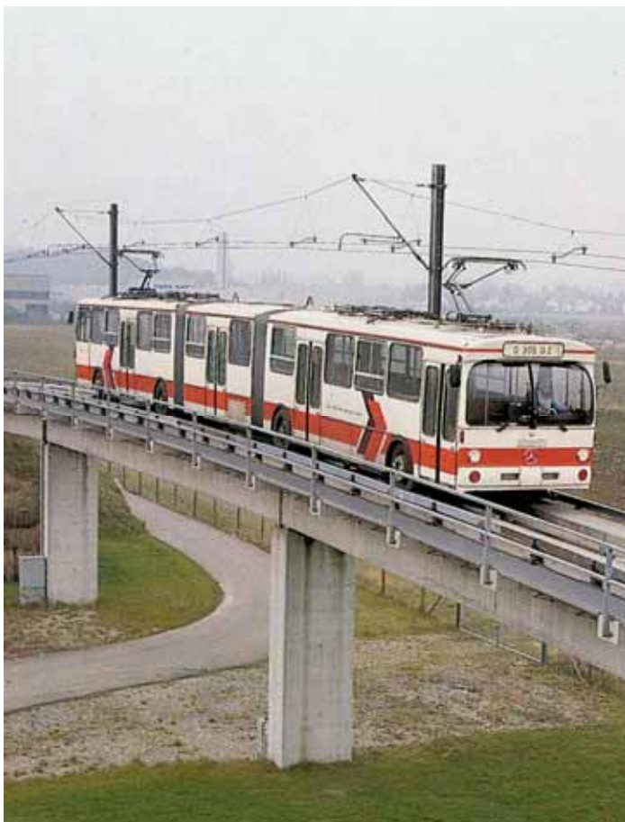
Tvåledat demonstrationsfordon för O-bahn med strömavtagare (pantograf) för spårväg. Fordonet en bussförarplats i ena änden och spårvägsförarplats i den andra – men får inte köra på gatunätet i Tyskland p g a sin längd - och kan inte köras utan kantstöd. (Reklam-broschyr från Mercedes)
