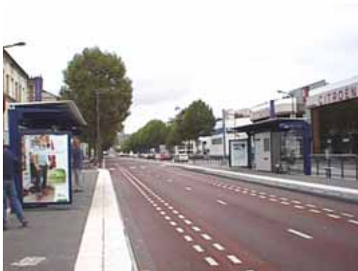
En hållplats med optisk guidning i gatan. Bilarna kör vid sidan om.
